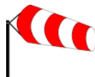
J7 Manche à air. Balise indiquant l'endroit où souffle fréquemment un vent latéral violent ainsi que l'intensité et la direction de celui-ci
