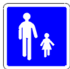
B54 Entrée d'aire piétonne
